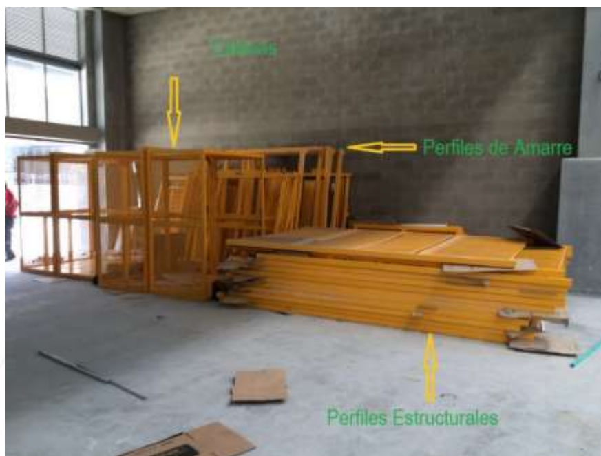
Imagen 5. Elevador Industrial COLDESA des armado y almacenado.
